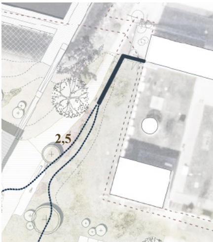
Klimasikring i terræn som afsluttes i terrænmur under terrassen ved GLAS
