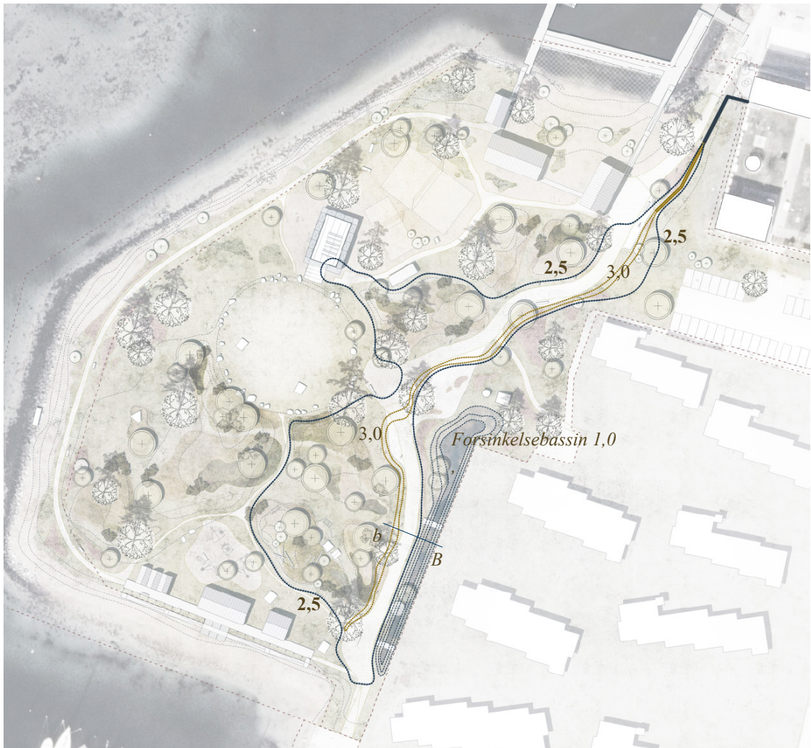
Princip for klimasikring i Folkeparken i hhv. kote 2,5 integreret i promenaden og kote 3,0 som dige øst for promenaden. Forsinkelsesbassin med rørforing under diget og promenaden og afløb på terræn til Trafikhavnen
